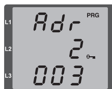
Fig. TCP / IP address, byte 2, value 003
